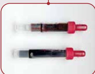
SortPro erkennt, ob bei Aspirationsproben der Stempel vollständig aufgezogen wurde. Proben, bei denen das nicht der Fall ist, können so rechtzeitig identifiziert werden, bevor sie Schwierigkeiten in der Analyse verursachen. Der Fehler kann dem LIS gemeldet und/oder die Probe von den fehlerfreien Proben getrennt werden.
