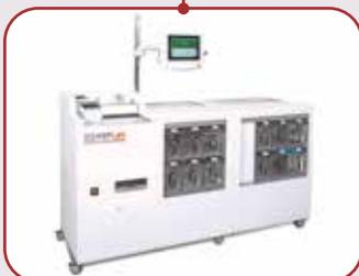
Sechs weitere Sortierziele bietet das Erweiterungsmodul. Es wird vom Basisgerät mit Strom versorgt und gesteuert. Das Erweiterungsmodul verfügt über Zielfachanzeigen und kann mit Zielfachpuffern ausgerüstet werden.
