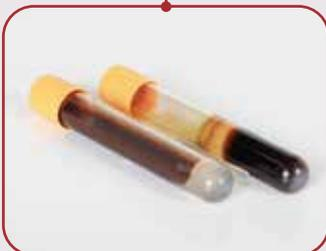
Nur vollständig zentrifugierte Proben liefern in der Analyse korrekte Ergebnisse. SortPro kann dieses wichtige Qualitätsmerkmal überprüfen und nicht ausreichend zentrifugierte Proben identifizieren. Diese Information wird an das LIS gemeldet und/oder die betroffene Probe wird in ein gesondertes Zielfach sortiert.
