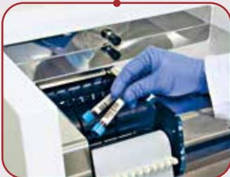
Um Proben zu priorisieren, können diese bei laufendem Gerät direkt in die aktive Vereinzelungseinheit gegeben werden. Diese Proben werden dann innerhalb von wenigen Sekunden verarbeitet. Der laufende Prozess wird dafür automatisch unterbrochen und läuft anschließend sofort weiter. Die priorisierten Proben können zusätzlich in der Labor-EDV als eilig markiert und auch gesondert ausgegeben werden.
