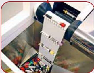
Die ältesten Proben werden immer als erste aus dem trichterförmigen Probeneingang gefördert. In der aktiven Vereinzelungseinheit wird jede Probe in die richtige Lage zur weiteren Verarbeitung gebracht, statt quer liegende Röhrchen wieder in den Trichter zurückzuwerfen. So ist die Verarbeitung der Proben mit höchster Effizienz und nach dem Fi-Fo Prinzip, bei gleichzeitig minimaler Bewegung jeder einzelnen Probe gewährleistet.
